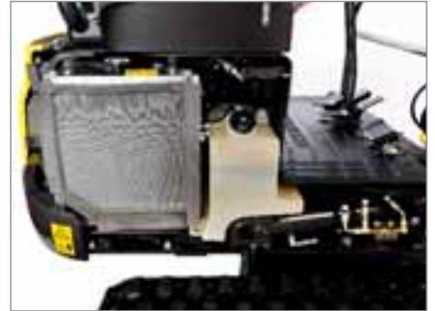
Indicatori di livello visibili dall'esterno, per un facile controllo dei livelli olio idraulico e carburante.
